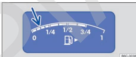
Fig. 50 En el cuadro de instrumentos: indicador del nivel de gasolina o gasóleo.
