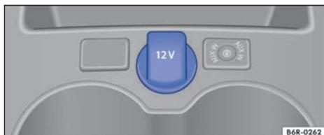
Fig. 138 En la parte delantera de la consola central: toma de corriente de 12 voltios.
