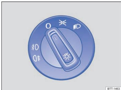
Fig. 85 Junto al volante: mando de las luces (una variante).
