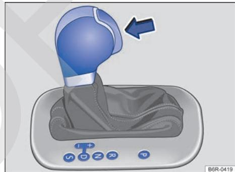
Fig. 110 Vehículo con el volante a la derecha: palanca selectora del cambio automático con tecla de bloqueo (flecha).
