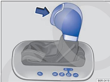
Fig. 109 Vehículo con el volante a la izquierda: palanca selectora del cambio automático con tecla de bloqueo (flecha).
