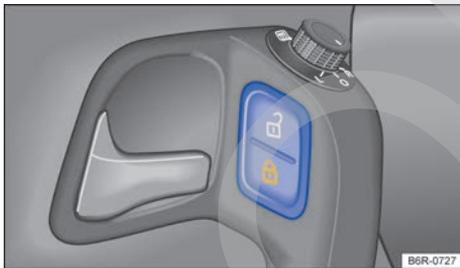
**Fig. 57** En la puerta del conductor: tecla del cierre centralizado.
