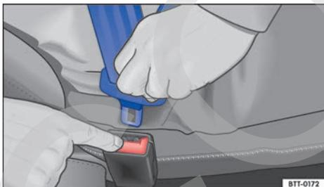
Fig. 9 Soltar la lengüeta del cierre del cinturón.
