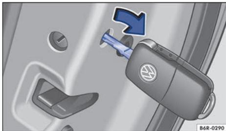
**Fig. 64** En el frontal de la puerta trasera derecha: bloqueo de emergencia del vehículo con la llave del vehículo.
