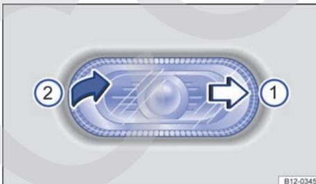
Fig. 170 Lado izquierdo del vehículo: desmontar el intermitente lateral.
