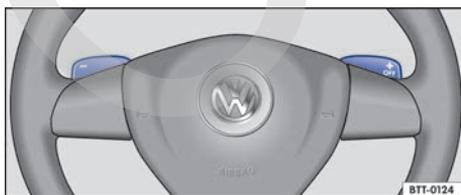
**Fig. 112** Volante con levas de cambio para el Tiptronic.
