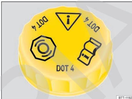
Fig. 198 En el vano motor: tapa del depósito del líquido de frenos (variante 1).
