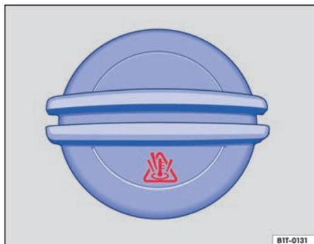
**Fig. 197** En el vano motor: tapa del depósito de expansión del líquido refrigerante del motor.
