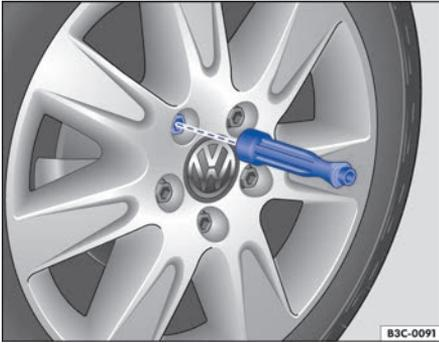
**Fig. 218** Cambio de rueda: desenroscar los tornillos de rueda con el mango del destornillador.
