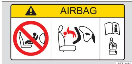
Fig. 23 Representación esquemática: etiqueta adhesiva relativa al airbag en el parasol.
