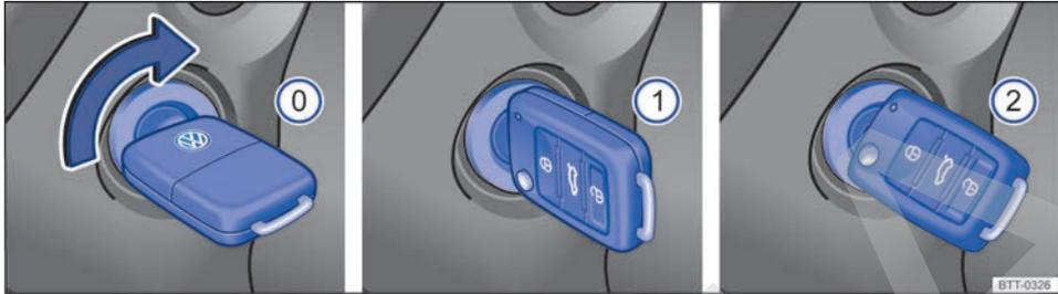
Fig. 105 Posiciones de la llave del vehículo en la cerradura de encendido.
