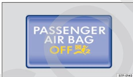
Fig. 13 En la parte superior de la consola central: testigo de control de la desactivación del airbag frontal del acompañante.
