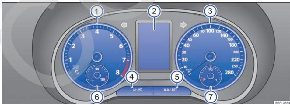
Fig. 47 Cuadro de instrumentos en el tablero de instrumentos: variante 2.
