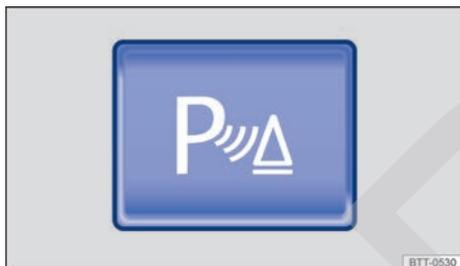
**Fig. 117** En la consola central: tecla para conectar y desconectar el ParkPilot (en vehículos con sensores en la parte delantera y en la parte trasera).
