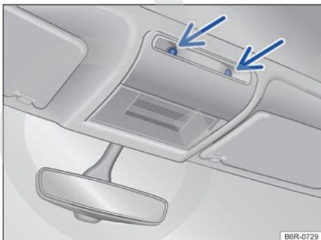
**Fig. 59** En la consola del techo: sensores de la vigilancia del habitáculo (flechas).
