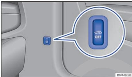
**Fig. 58** Junto al asiento del conductor: tecla para desconectar la vigilancia del habitáculo y el sistema antirremolcado.
