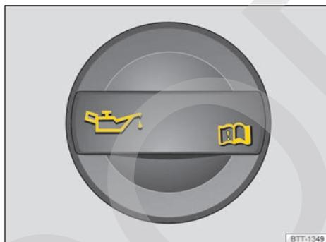
Fig. 195 En el vano motor: tapa de la boca de llenado de aceite del motor (representación esquemática).
