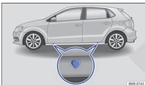
Fig. 216 Puntos de apoyo para el gato (el lado derecho del vehículo es simétrico).
