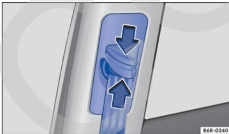
**Fig. 12** Junto a los asientos delanteros: regulador de la altura del cinturón.
