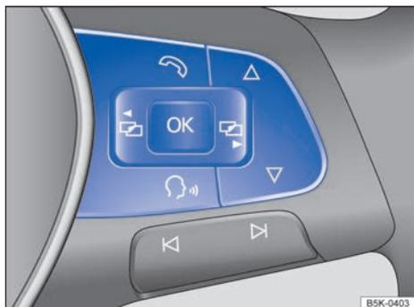
Fig. 52 En el lado derecho del volante multifunción: teclas para utilizar los menús del cuadro de instrumentos.
