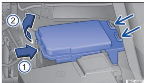
Fig. 181 En la parte delantera izquierda del vano motor: cubierta de la caja de fusibles.
