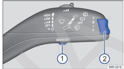
**Fig. 51** En el lado derecho de la columna de dirección: palanca del limpiacristales para manejar el cuadro de instrumentos.
