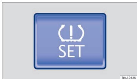
Fig. 201 En la guantera: tecla del sistema de control de los neumáticos.
